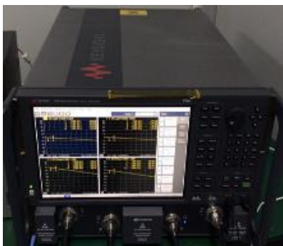
ベクトルネットワークアナライザー + Dk & Dfテストシステム
